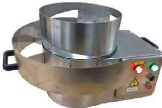
Рисунок 3 – Центробежная калибровочная машина
